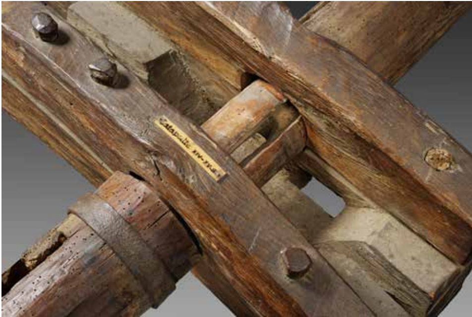
Abb. 19: Reste der eigentlichen Haspelwinde an der Armbrustwinde Inv.-Nr. MV 5 im Musée d'histoire du Valais, Sion (CH). Zu sehen ist der Schlitz in der Welle mit den seitlichen Aussparungen. Durch diesen könnte der Spanngurt geführt und um einen Sicherungsstift gelegt worden sein.
