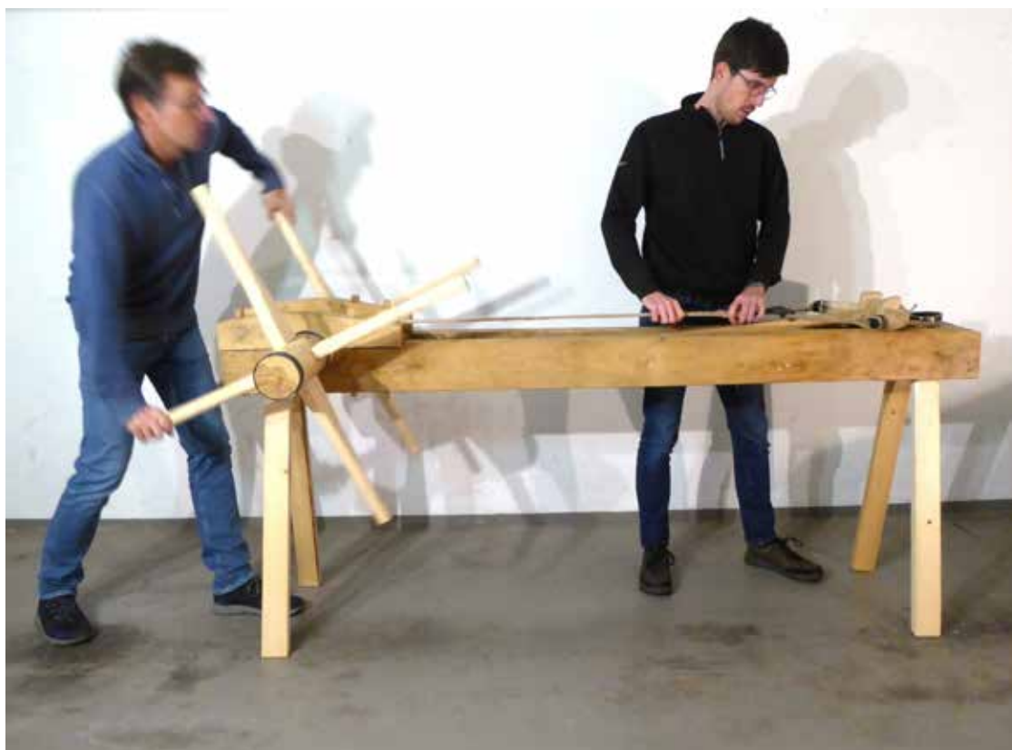
Abb. 69: Spannversuche mit einer Rekonstruktion der Armbrustwinde MV 5 des Musée Cantonal in Sion vgl. Abb. 10 und 11.
