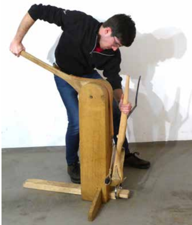
Abb. 70: Spannversuche mit einer Rekonstruktion des Spannhobels aus Konrad Kyesers Bellifortis vgl. Abb. 27.
