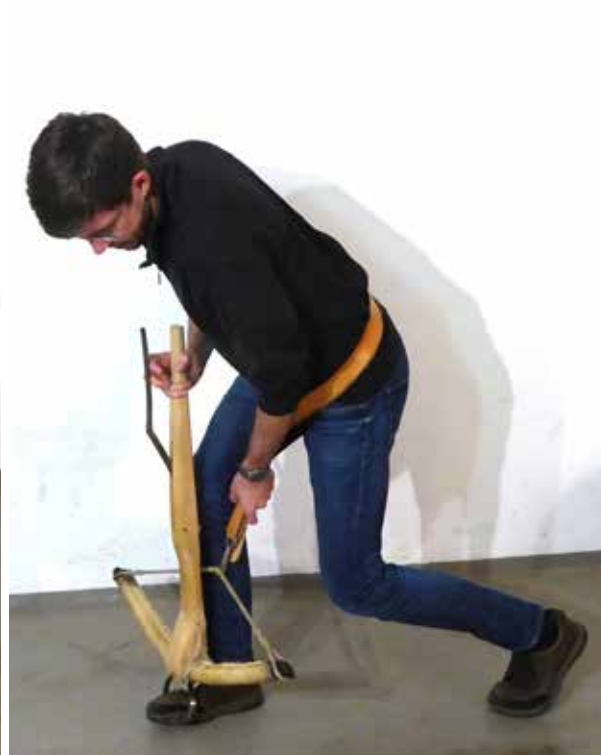
Abb. 71: Spannversuche mit einer Rekonstruktion des Spanngürtels mit dem Haken aus Dublin Kat.-Nr. 12.2.
