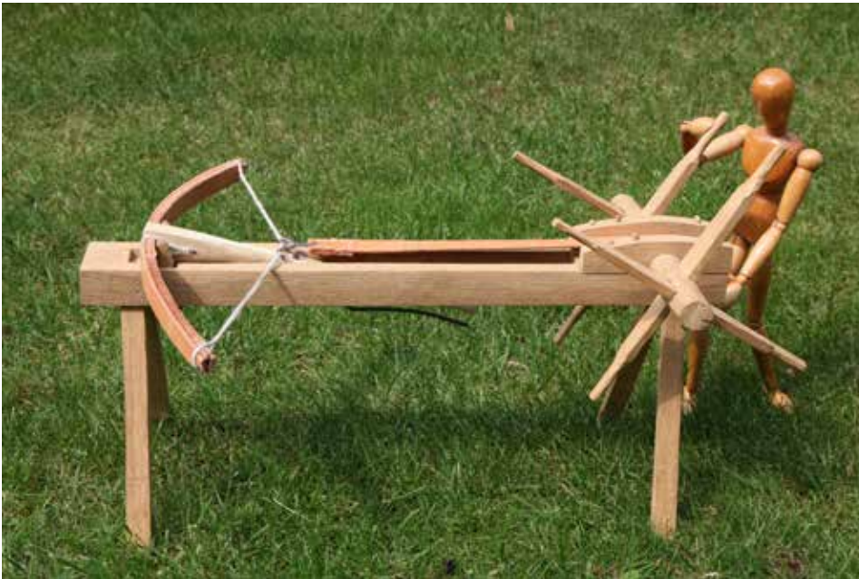
Abb. 20: Rekonstruktionsmodell der Winde MV 5 aus dem Musée d'histoire du Valais in Sion (CH) mit maßstabsgetreuer Person.
