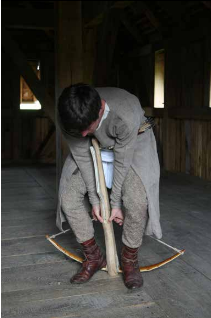
Abb. 72: Spannversuch einer rekonstruierten Armbrust mit dem Bogen aus Berkhamsted mit der stehenden Zweifuß-Methode.
